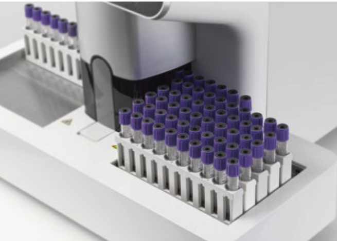
Autocargador con capacidad para 60 muestras con carga continua
