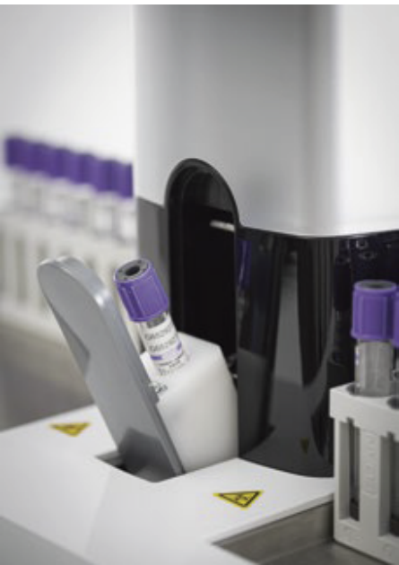
Posición STAT Cambio fácil del cargador automático
