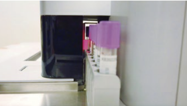
Rotación y reconocimiento automáticos del ID de la muestra
